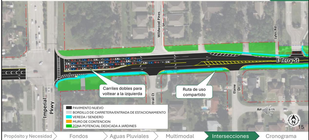
Este proyecto modificará los carriles para voltear en dirección oeste en la intersección de East Terry Street con Imperial Parkway proporcionando carriles dobles al tráfico en dirección oeste para voltear a la izquierda hacia el sur y un carril más largo para el tráfico en dirección oeste para voltear a la derecha. Estas mejoras aumentarán la capacidad de las intersecciones y reducirán sustancialmente congestiones de tráfico.
