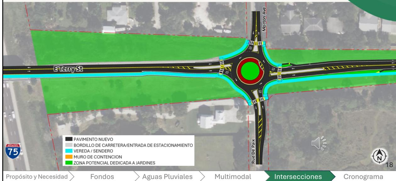
Para crear un nuevo flujo de tráfico más fluido en la intersección con Morton Avenue, el proyecto propone un ovalo o rotonda de un solo carril que reemplace la intersección existente en East Terry Street y Morton Avenue.
